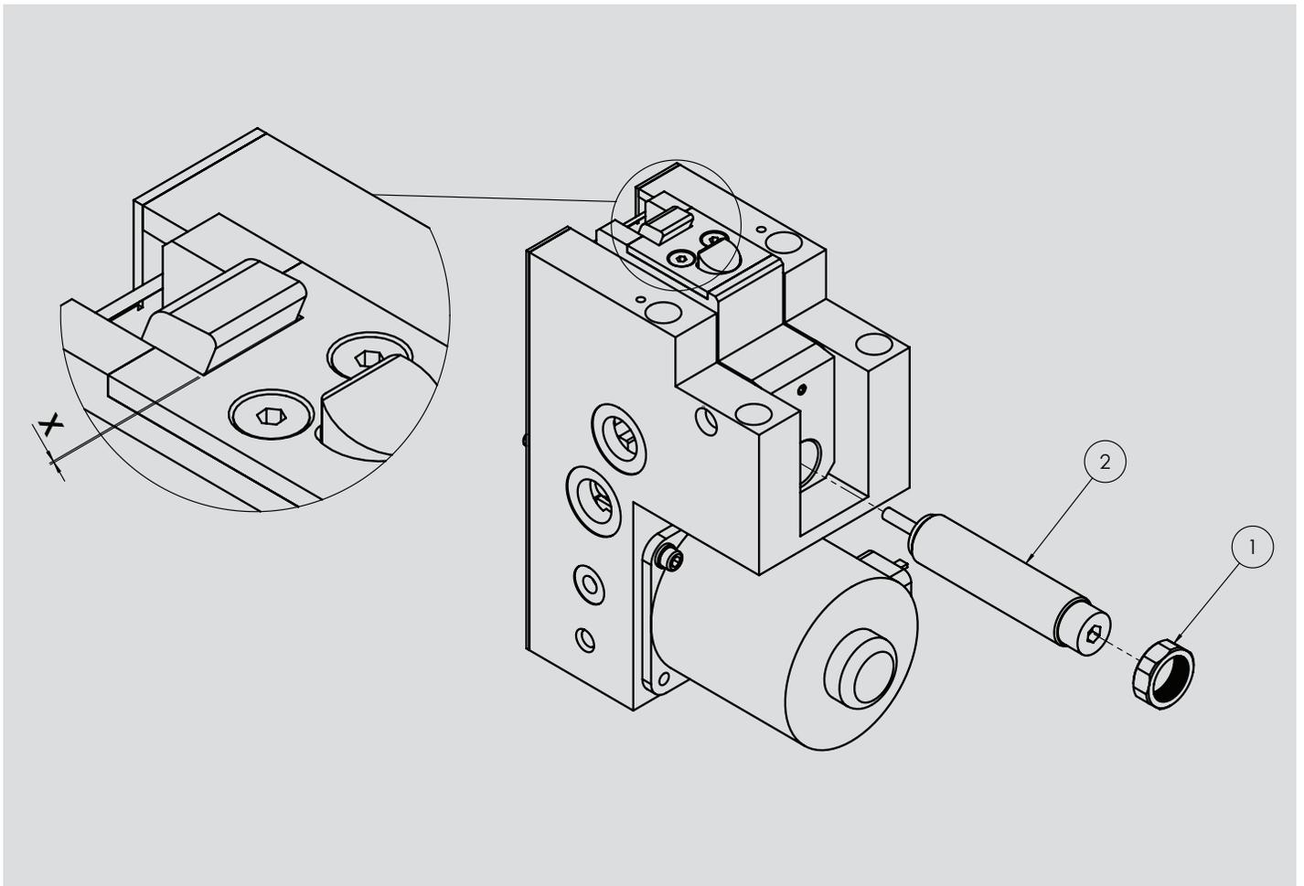
Die Dämpfeinheit ist ein Verschleißteil und muss je nach Einsatzbedingungen zwischen 1 Mio. und 4 Mio. Zyklen ausgetauscht werden.
