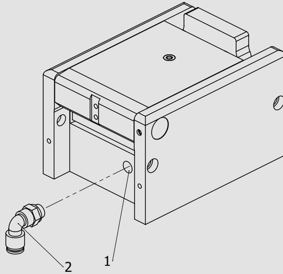
Den Druckluftanschluss („2“) über Luftanschluss („1“) mit dem zugehörigen Schaltventil verbinden.
