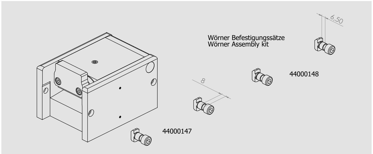
Bei Verwendung von eigenen Befestigungssätzen bitte darauf achten, dass die Festigkeitsklasse min. 8.8 beträgt. Die Einschraubtiefe muss min. 7,5 mm betragen.
